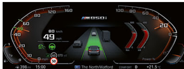
AUTOMATYCZNY ASYSTENT OGRANICZEŃ PRĘDKOŚCI 1,* DYNAMICZNIE DOSTOSOWUJE AKTYWNY REGULATOR PRĘDKOŚCI DO ZBLIŻAJĄCYCH SIĘ OGRANICZEŃ PRĘDKOŚCI.
