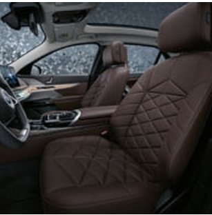
Fotele standardowe z przodu z podparciem lędźwiowym, ogrzewaniem i elektryczną regulacją z funkcją pamięci, także dla ustawień lusterek zewnętrznych i kolumny kierownicy.
