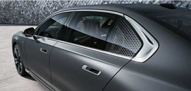
Szyby przeciwsłoneczne z tyłu i jako tylne szyby boczne ograniczają niepożądane nagrzewanie się wnętrza.
